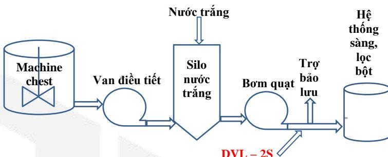
Lưu ý: để hiệu suất phản ứng tốt nhất, tránh hiện tượng phản ứng cục bộ, gây kết tủa trong hệ thống, điểm châm màu phải trước điểm châm trợ bảo lưu, đảm bảo khoảng cách không quá gần; nên sử dụng cùng hệ màu khi sử dụng kết hợp với màu nước khác.
