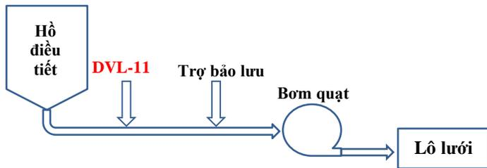
Với máy xeo lưới dài: Dùng bơm định lượng bơm online cấp vào đường ống dẫn dung dịch bột sau bơm quạt, trước hệ thống sàn lọc bột của máy xeo giấy.
